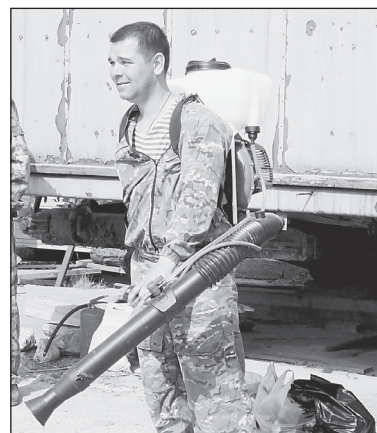
Зажигательный аппарат используется для пуска встречного огня или отжига от опорной полосы
