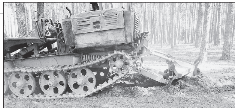
Навесное оборудование к трактору эффективно используют не только для посадок, но и для устройства минерализованных полос
